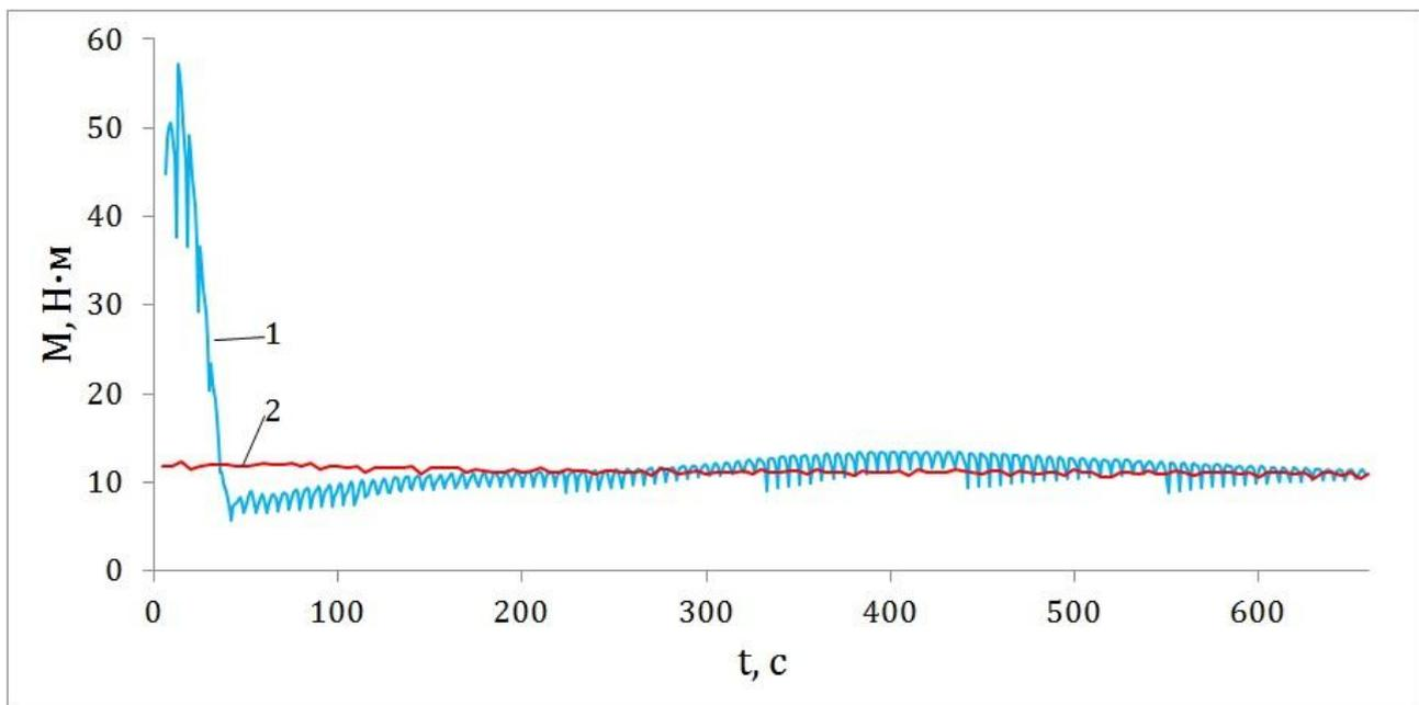
Рис.4. Временные зависимости суммарных моментов трения: 1- восстановленные по температурным данным; 2 – измеренные индуктивным датчиком момента трения
