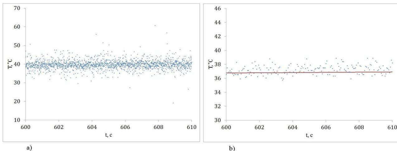
Рис.2. Характерные температурные данные: а) замеры температур модулем L-Card E502 при  $\varphi = 15^\circ$  на расстоянии 0,5 мм от зоны трения на
