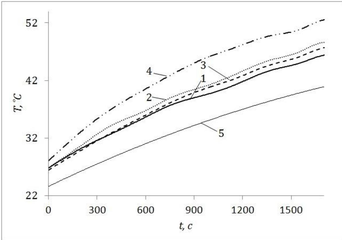
Рис.3. Измеренные временные зависимости температур: (1-4) – в подшипниках с соответствующими номерами при  $\varphi = 15^\circ$  на расстоянии 0,5 мм от зоны трения; 5 – на поверхности конца вала
