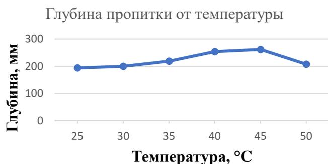
Рис. 1. График зависимости глубины пропитки от температуры при толщине слоя песка  $L = 300$  мм, давление на верхней поверхности песка  $p_1 = 10000$  Па, на нижней  $p_2 = 0$  Па, пористость песка  $m = 0.38$ , проницаемость песка  $k = 1.18 \cdot 10^{-10}$  м<sup>2</sup>
