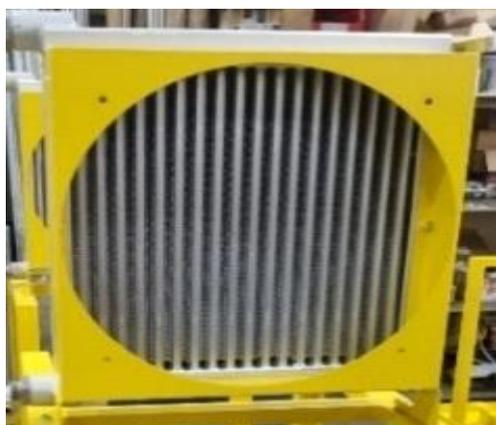
Рис. 1. Многосекционный конвективный теплообменный аппарат
